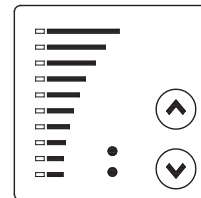
Рис. 21 Панель управления насоса СМЕ
