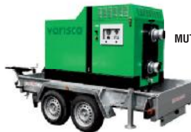
MUTELINE 6" - Cabina silenziate su carrello Silenced proof canopy on trailer
